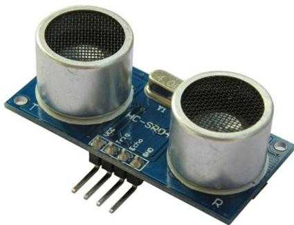
Fig. 2.3 Sensor por ultrasonido
